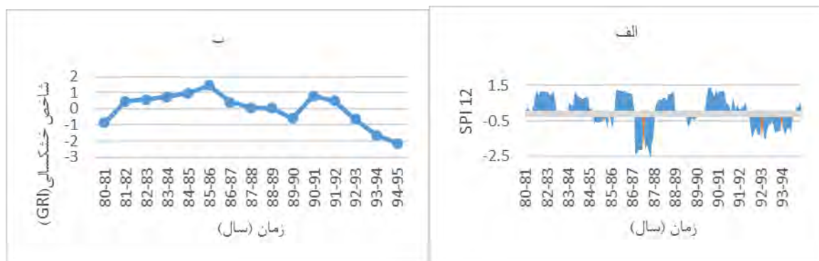
شکل ۴. وضعیت خشکسالی الف) خشکسالی هواشناسی ایستگاه کارخانه قند نیشابور ب) خشکسالی آب زیرزمینی چاه پیژومتری تقی-آباد
