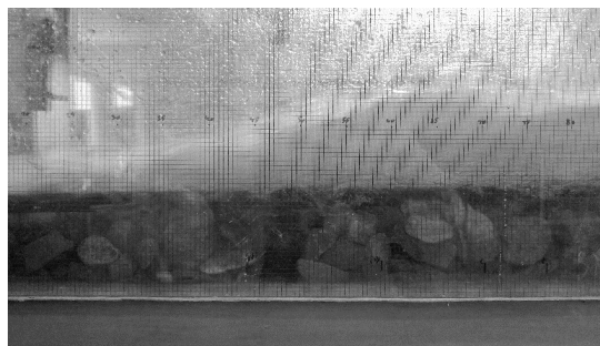
شکل 2 پرش هیدرولیکی تشکیل شده بر روی بستر نفوذپذیر کانال
