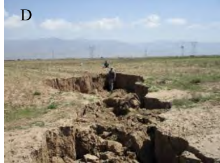
شکل ۴ ترک های ناشی از فرونشست نهشته های کواترنری در دشت نیشابور روستای بشرو (A,B) و کاریزک کنار کال (D,C)
