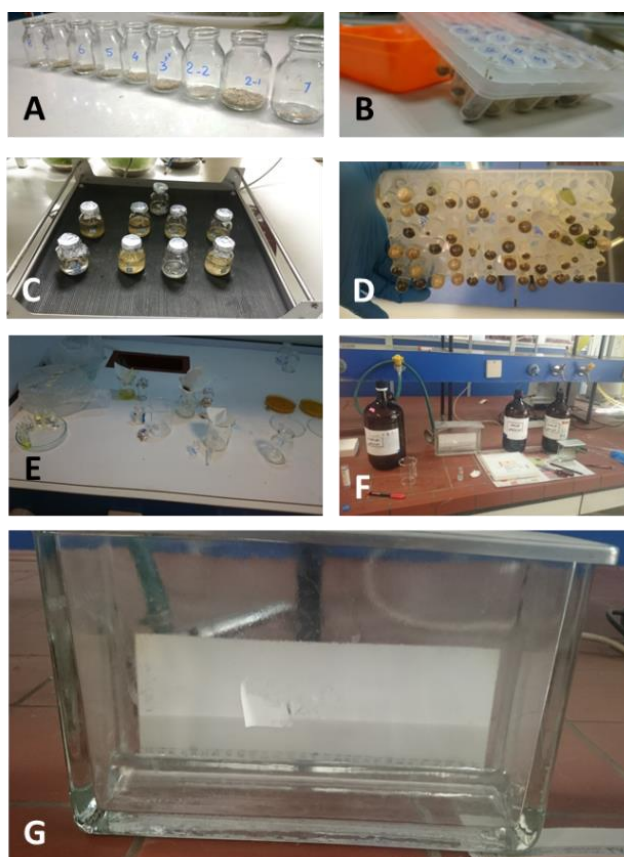
شکل ۱- مراحل آماده‌سازی نمونه‌ها جهت انجام TLC: A: کدگذاری نمونه‌ها بعد از اندازه‌گیری وزن، B: افزودن حلال به نمونه‌ها به نسبت ۶ به ۱، C: قرار دادن نمونه‌های بیش از ۵ گرم بر روی شیکر برای حل شدن بهتر در حلال، D: سونیکیت نمونه‌های با وزن کمتر از ۱ گرم در حمام آب، E: عصاره‌گیری زیر هود شیمیایی با استفاده از کاغذ صافی، F: آماده‌سازی سیستم حلال به منظور انجام TLC، G: لکه‌گذاری و انجام TLC
