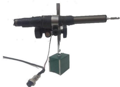
شکل ۹ : تغییر مکان‌سنج الکترونیکی - مکانیکی
