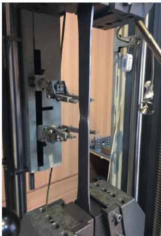
شکل ۴: نمونه‌ی فولادی استخوانی شکل استاندارد تحت آزمایش کشش تک‌محوره
