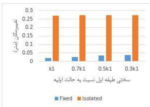
شکل ۶- نمودار میله ای تغییر مکان طبقه اول در حالات مختلف سختی برای سازه پایه ثابت و جداسازی شده در زلزله السسترو
