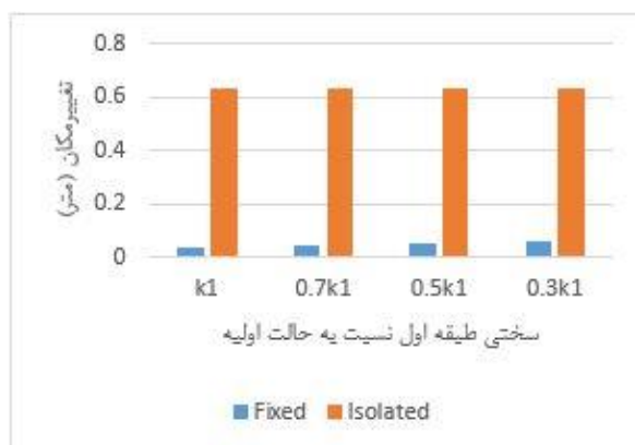
شکل ۷- نمودار میله ای تغییر مکان طبقه اول در حالات مختلف سختی برای سازه پایه ثابت و جداسازی شده در زلزله طیس
