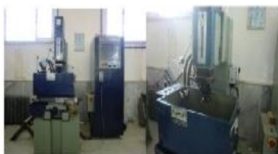
شکل 2- دستگاه تخلیه الکتریکی مورد استفاده در انجام آزمایشات
