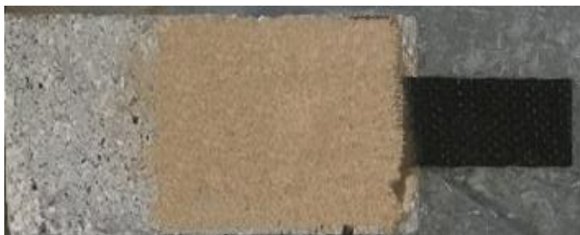
شکل ۳: سطح پوشانده شده نمونه توسط ماسه رنگی
