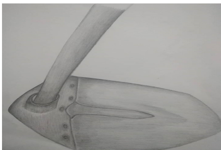
شکل ۵- تیشه پنج میخ سیستان جهت حفر گودال یا کورق در سطح دریاچه
