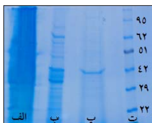
شکل ۲) ژل الکتروفورز آنزیم کتکول (۲) دی‌اکسیژناز؛ الف) عصاره خام؛ ب) نمونه ۱ (ستون در مرحله اول؛ پ) آنزیم خالص؛ ت) مارکر وزن مولکولی (کیلوالتون)
