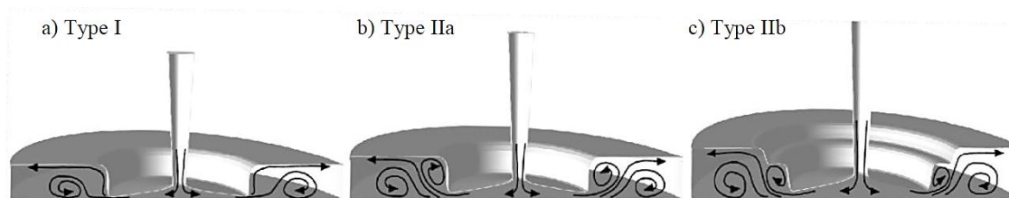
شکل ۳- شماتیک انواع ساختار پرش‌های هیدرولیکی دایروی [۶]
