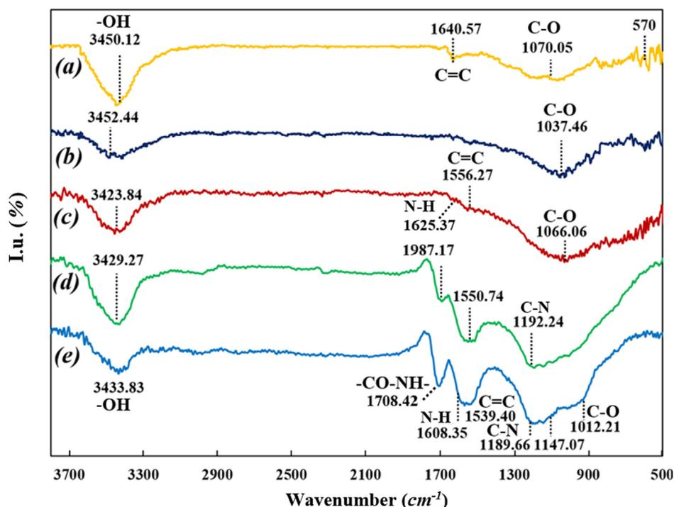
Fig. 3. FT-IR spectra of (a) raw anthracite, b) AC, c) AC-U, d) AC-OX and e) AC-OX-U.
