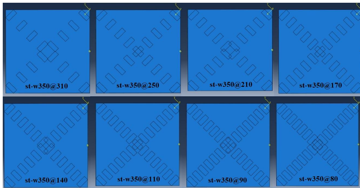
شکل ۸- دال تقویت شده با نوار FRP به پهنای ۳۵۰ میلیمتر و فواصل مختلف
