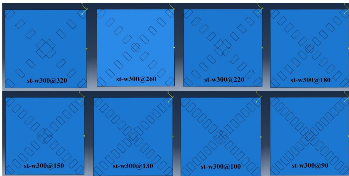
شکل ۷- دال تقویت شده با نوار FRP به پهنای ۳۰۰ میلیمتر و فواصل مختلف
