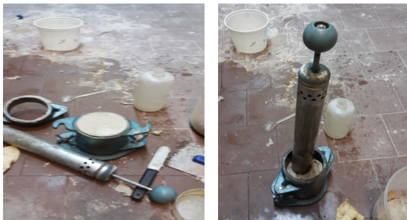
شکل ۳: انجام آزمایش تراکم پروکتور استاندارد بر روی خاک حاوی گازوئیل (سن ۴۲ روز)
