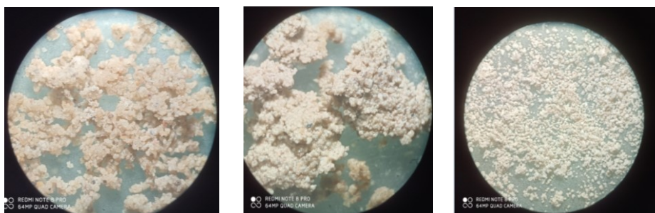
شکل ۱۱: الف) نمونه خاک ماسه رسی سالم ب) خاک محتوی گازوئیل پس از ۱۴ روز ج) خاک محتوی گازوئیل پس از ۴۲ روز
