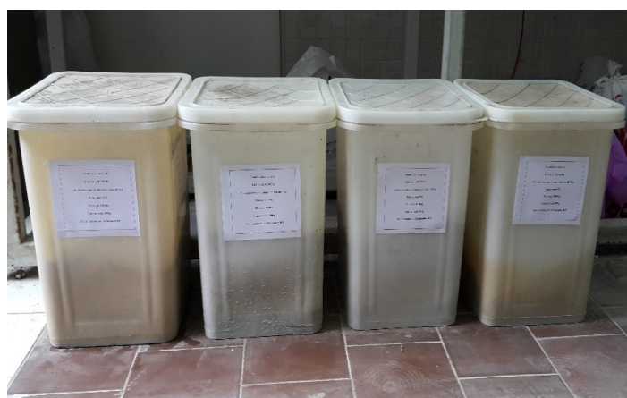
شکل ۲: شرایط نگهداری خاک های آلوده شده توسط گازوئیل در آزمایشگاه
