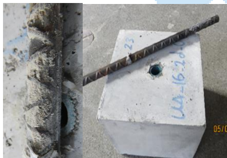
ب) حالت گسیختگی بیرون کشیده شدن میلگرد
