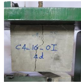
ج) حالت گسیختگی بیرون کشیده شدن میلگرد همراه با گسترش ترک به سطح (حالت ترکیبی)
