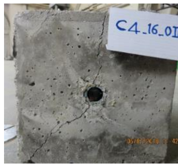
ج) حالت گسیختگی بیرون کشیده شدن میلگرد همراه با گسترش ترک به سطح (حالت ترکیبی)
