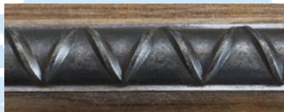
شکل ۲: هندسه آج‌های میلگردهای مورد استفاده در پژوهش
