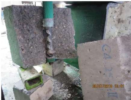
د) حالت گسیختگی شکافت بتن
