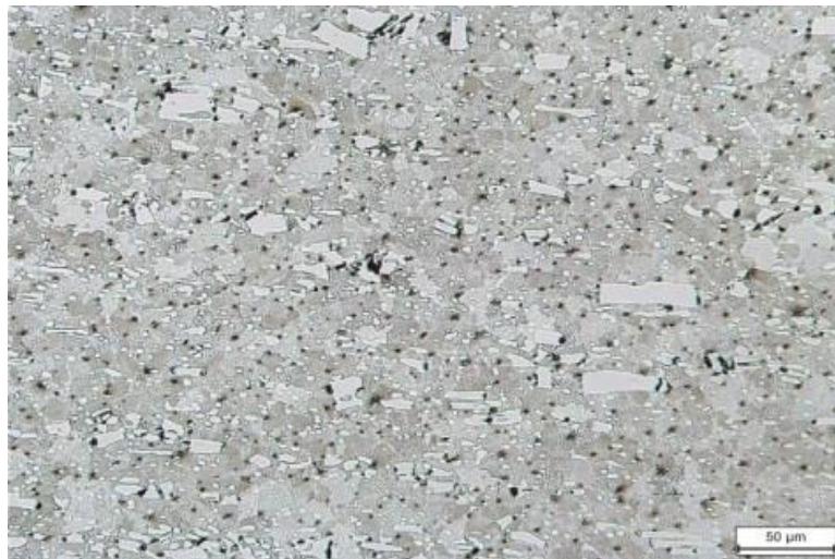
شکل ۳. تصویر میکروسکوپی نوری نمونه گرافیت‌زایی ۱۰ ساعت با زمینه آستنیتی.
