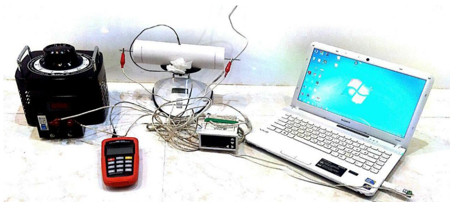
شکل (۱) سامانه گرمایش اهمی به کار رفته در این تحقیق Fig (1) Ohmic heating system.
