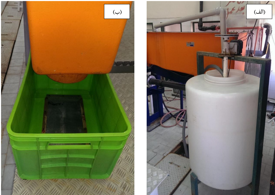
شکل ۳. الف) مخزن تولید جریان غلیظ؛ ب) صافی جداسازی مواد Fig. 3.a) Concentrated flow generation tank; b) Material separation filter
