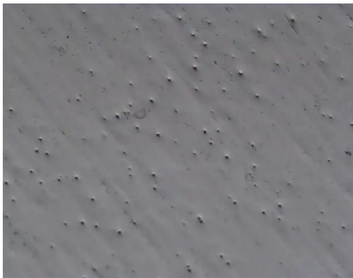
شکل ۶- بررسی درصد تخلخل الف: در لبه و ب: در مرکز نمونه یک.
