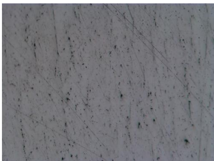
شکل ۱۰- بررسی درصد تخلخل الف: در لبه و ب: در مرکز نمونه پنج.
