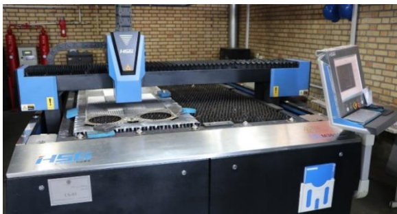
شکل ۱) دستگاه برش لیزر فایبر با توان ۷۵۰ وات
