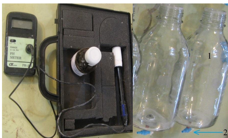
شکل ۴- راست: ۱- هاضم ۲- شیر تعبیه شده در کف هاضم؛ چپ: تصویر اسیدیته سنج مورد استفاده در آزمایشات
