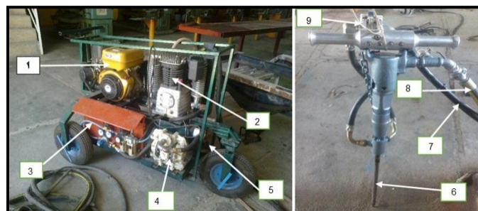
شکل ۱- نمای کلی از دستگاه تولید قدرت و کنترل تزریق فشار (چپ)، چکش تزریق مورد استفاده در طرح حاضر (راست) (۱- مولد قدرت بنزینی، ۲- کمپرسور تولید هوای فشرده، ۳- واحد کنترل، ۴- پمپ دیافراگمی، ۵- کپسول‌های ذخیره‌سازی هوای فشرده، ۶- نازل تزریق، ۷- شیلنگ سیال، ۸- شیلنگ هوای فشرده و ۹- شیر برقی)
