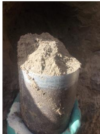
شکل ۲- نمونه‌برداری از خاک برای آزمایش تخلخل
