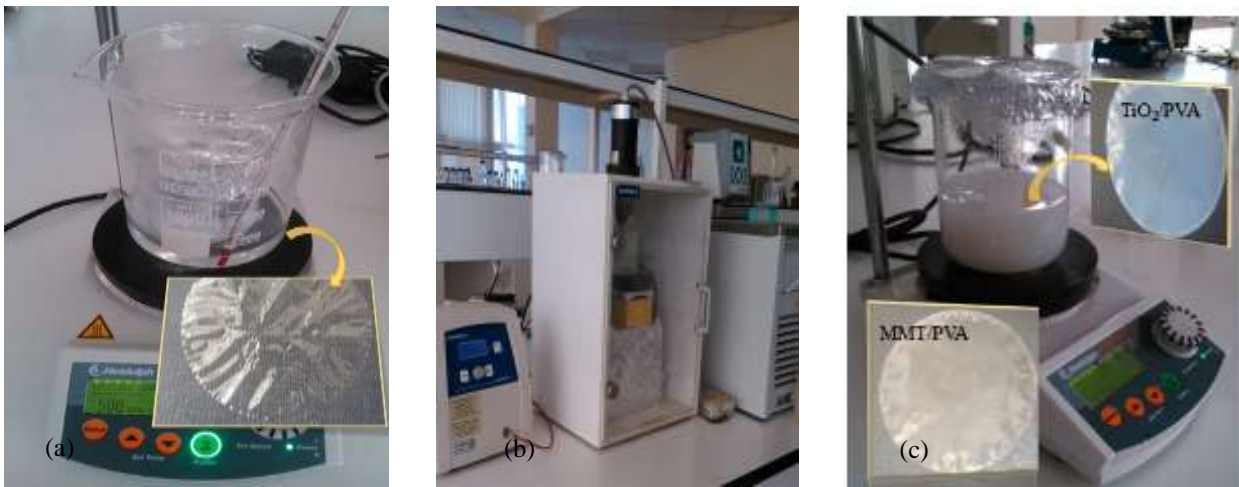
شکل ۱- آماده‌سازی فیلم‌های نانوکامپوزیتی، (a) پلیمر خالص PVA، (b) هم‌وزن‌ایزر اولتراسونیک، (c) نانوکامپوزیت MMT/PVA و TiO 2 /PVA.
