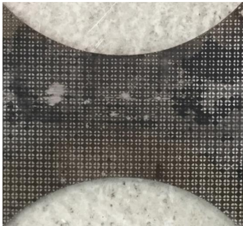
شکل ۲. گریدبندی روی نمونه‌های آماده شده برای تست اریکسون.
