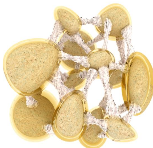
شکل ۳ شماتیک نحوه شکل‌گیری رسوب کلسیم کربنات بین دانه‌های آلوده هیدروکربنی
