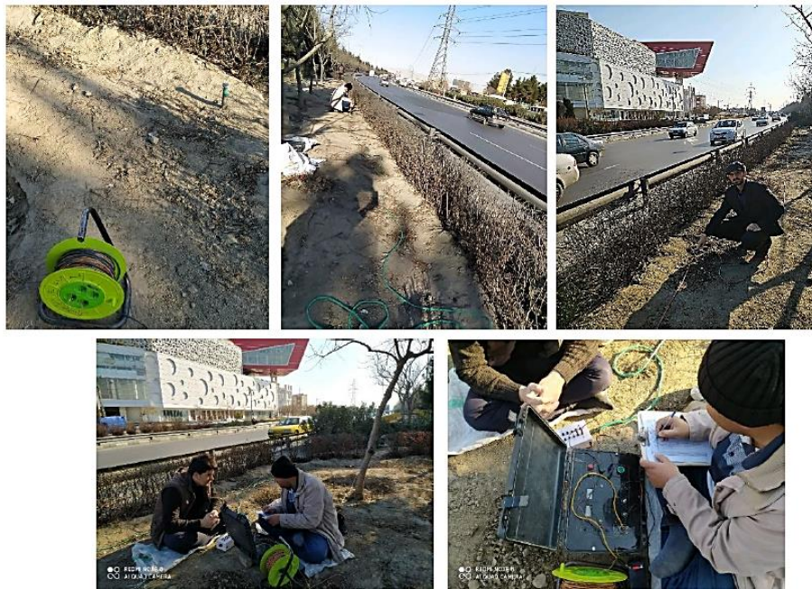
شکل ۳- انجام آزمایش توموگرافی الکتریکی دو بعدی [۱]
