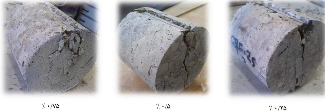
شکل ۶- مود شکست کششی بتن روسازی حاوی (الف) ۰/۲۵٪، (ب) ۰/۵٪، و (ج) ۰/۷۵٪ الیاف فولادی بازیافتی [۲۹]
