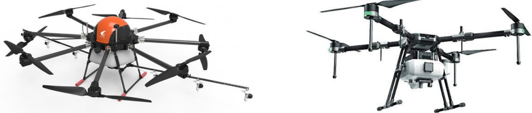
شکل 1. راست: پهپاد سمپاش با آرایش نازل ها در زیر موتور ها، چپ: پهپاد سمپاش با آرایش نازل ها به صورت خطی.
