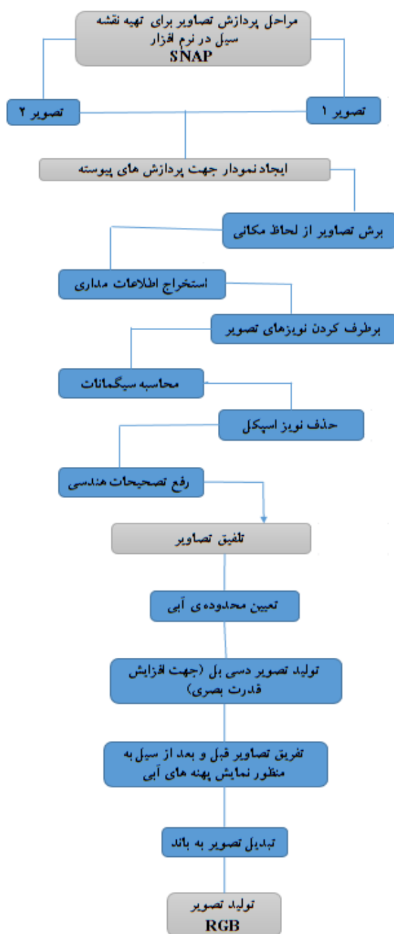
شکل ۲: فلوچارت مراحل انجام تهیه نقشه‌های RGB سیل
