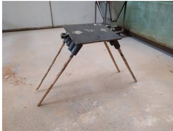
شکل ۲- پی تقویت شده با ۴ ریزشمع در زاویه ۳۰ درجه
