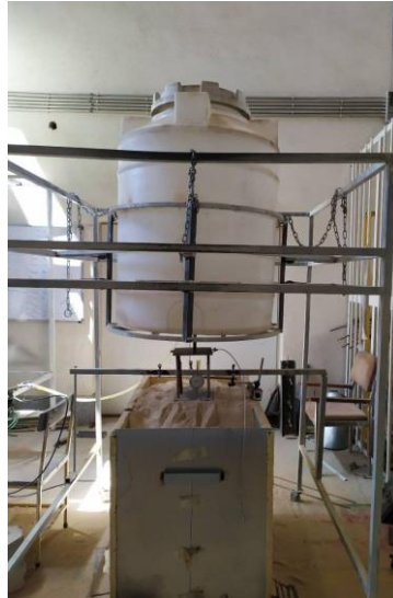
شکل ۳- نمایی از قاب بارگذاری و وسایل اندازه‌گیری
