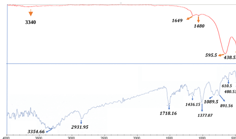
شکل ۲- طیف مادون قرمز الف) نانوذرات \text{CoFe}_2\text{O}_4 ، ب) نانوالیاف کامپوزیتی \text{PVA/CoFe}_2\text{O}_4
