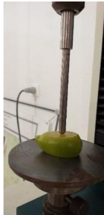
شکل ۶) استفاده از تئوری بوسینسک برای تعیین مدول الاستیسیته
