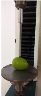
شکل (۴) فشردن پراب کروی با قطر معین بر روی میوه کامل لایم کوات در تئوری هرتز
