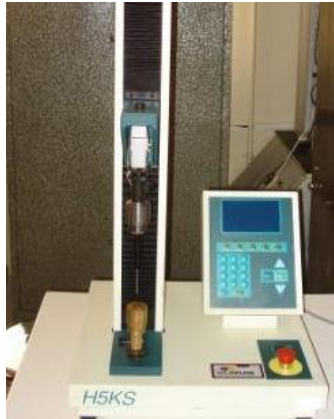
شکل ۲- دستگاه کشش- فشار اینسترون مورد استفاده در آزمایش
