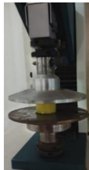
شکل ۲) نمونه استوانه‌ای میوه لایم کوات بین دو صفحه موازی در قانون هوک
