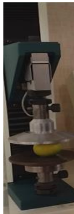
شکل ۳) فشردن محصول کامل بین دو صفحه موازی در تئوری هرتز
