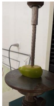
شکل (۵) فشردن پراب کروی با قطر معین روی نمونه مستطیلی از میوه لایم کوات در تئوری هرتز
