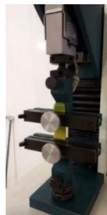
شکل ۷) آزمون کششی بر روی پوست محصول لایم کوات
