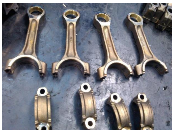
شکل ۷: بررسی سطح بوش بازوی لنگ‌ها پس از اتمام آزمون‌ها
