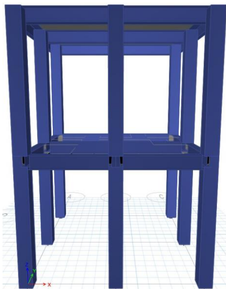
تصویر ۳ - مدل سازی قاب دو طبقه ساختمانی جهت قرائت وزن فعالیت ها
