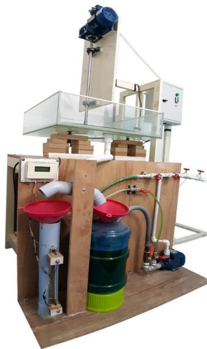
شکل ۷. نمای کلی دستگاه طراحی و ساخته شده برای ایجاد پرش‌های هیدرولیکی تحقیق حاضر
