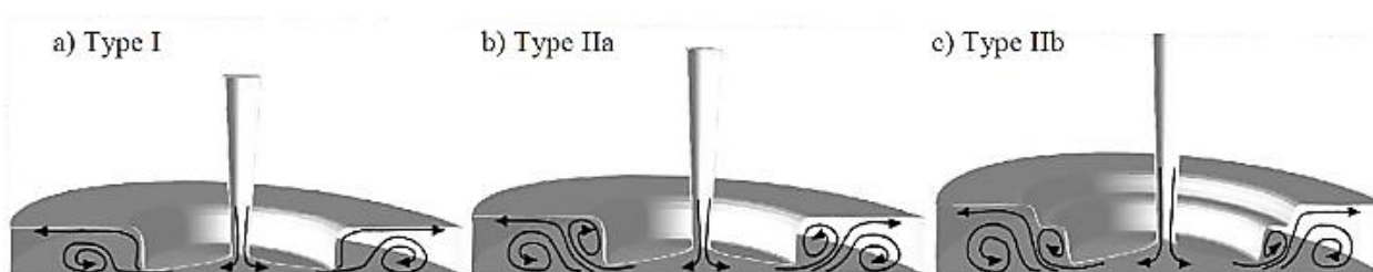
شکل ۲. شماتیک انواع ساختار پرش‌های هیدرولیکی دایروی [9] Fig. 2. A schematic illustration of the types of circular hydraulic jump structure [9]
