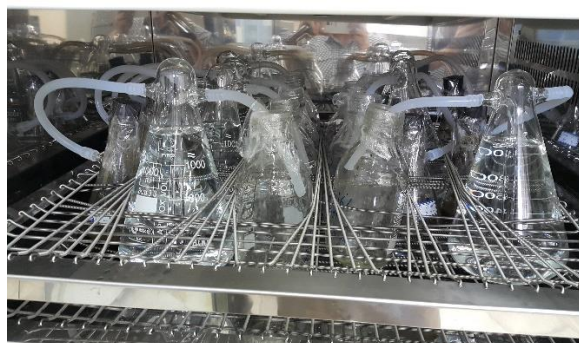
شکل ۱- نحوه قرارگیری بطری‌ها جهت اندازه‌گیری زیست‌گاز تولیدی
