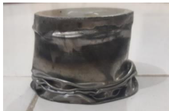
شکل (۸): تصاویر دو نمونه از مخروط‌های با قطر بزرگ ۷۰ میلی‌متر قبل و بعد از انجام آزمایش.
