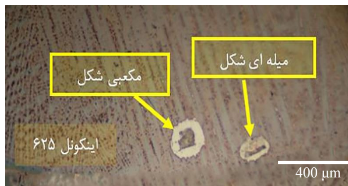
شکل ۷- شکل رسوبت ایجاد شده در سوپراآلیاژ اینکونل ۶۲۵ بعد از لایه نشانی لیزری نمونه ۳
