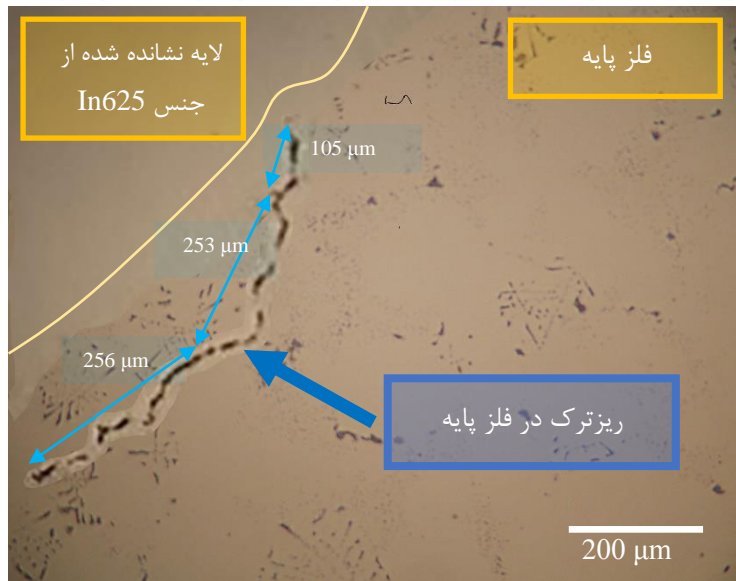
شکل ۶- تصویر در حالت پولیش مربوط به فرآیند لایه نشانی نمونه ۳ (توان ۸۰۰ وات)
