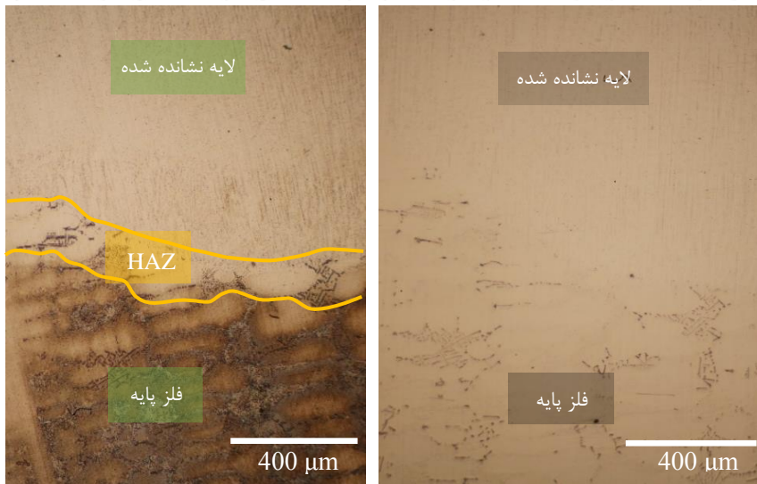
شکل ۳- ریزساختار نمونه لایه نشانی شده لیزری با توان ۷۰۰W (الف) در حالت پولیش (ب) در حالت اچ
