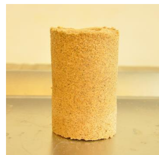
شکل ۳. نمونه‌های ماسه‌ای بهسازی شده در محیط آزمایشگاه پس از تکمیل فرآیند رسوب میکروبی القایی کربنات کلسیم
