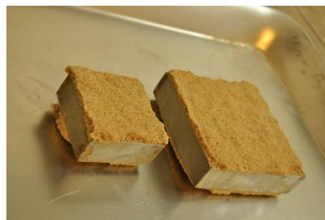
شکل ۶. نمونه دست نخورده آماده شده در قالب و آماده انتقال به قالب اصلی دستگاه برش مستقیم Fig. 6. Intact sample prepared in the mold and ready to transfer to the main mold of the direct cutting machine
