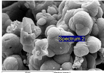
(الف) تصاویر SEM و نمودار EDS مربوط به رسوبات ناشی از باکتری‌های رشد کرده در محیط کشت NB
