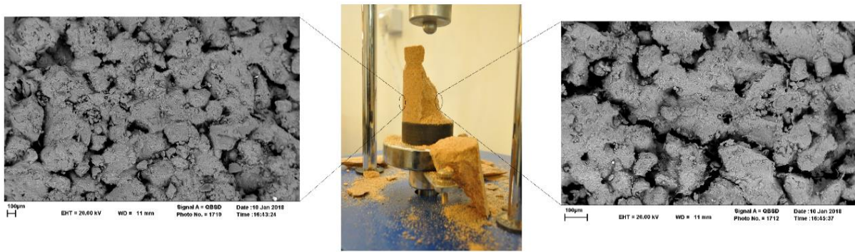
شکل ۴- نیم‌رخ شکست یک نمونه بهسازی شده در آزمون تک‌محوری
