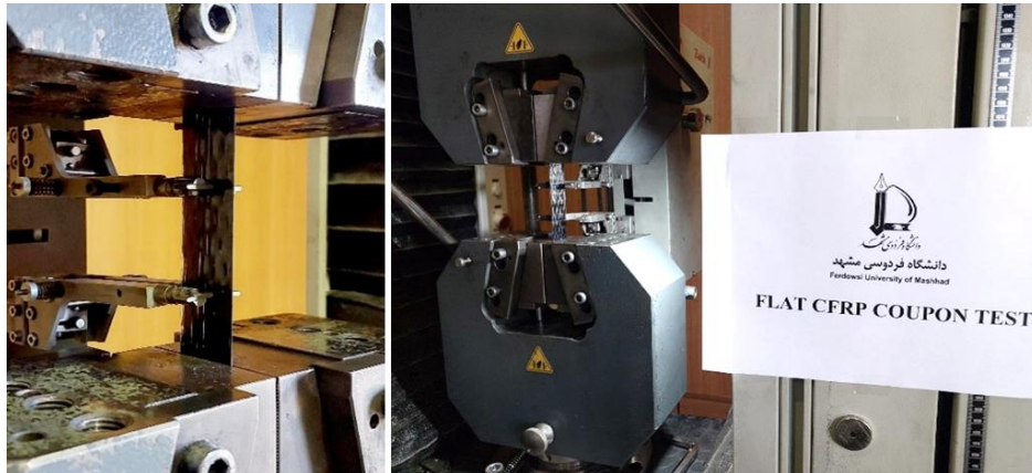
شکل ۱- آزمایش کشش مصالح مرکب CFRP
