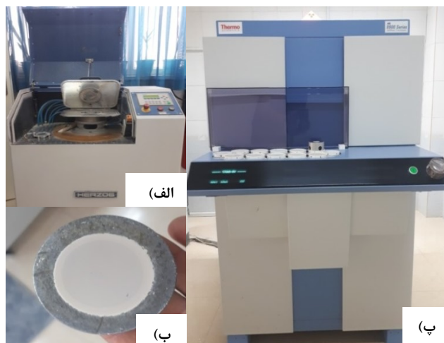
شکل ۳: تجهیزات آزمایش XRF (الف) دستگاه تهیه قرص، (ب) قرص تهیه شده و (پ) دستگاه تحلیل.
