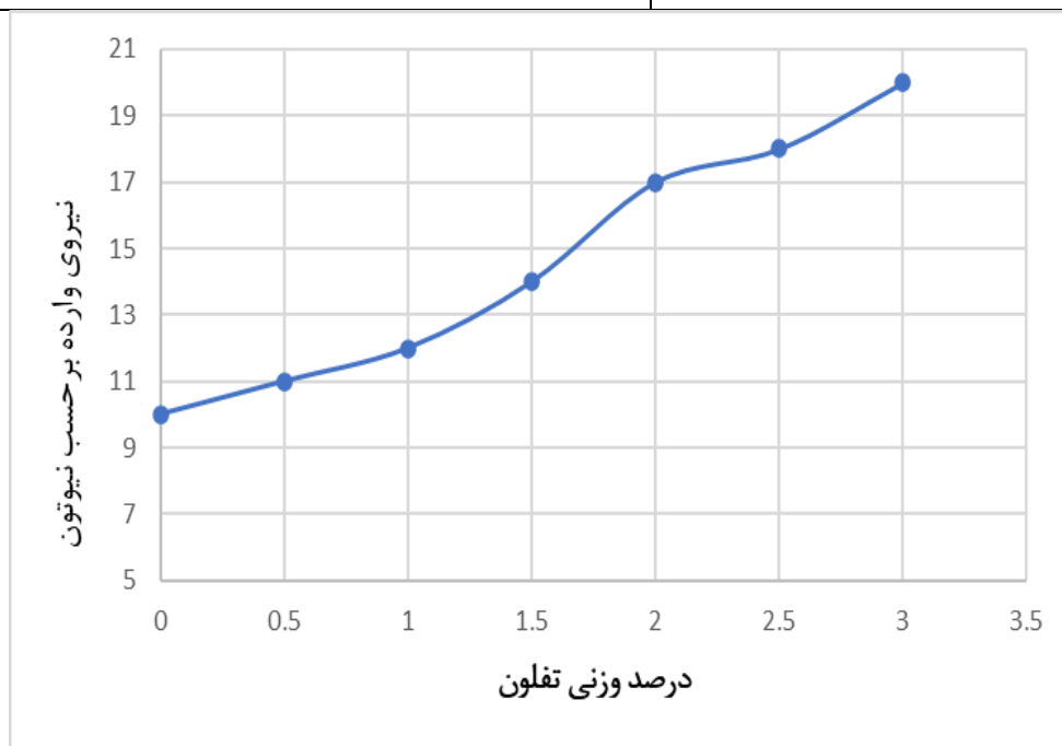
شکل ۱- نمودار مقاومت به خراش برای نمونه رنگ های دارای درصد های مختلف تفلون
