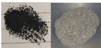
شکل ۴: سمت راست: تصویر آلیاژ خرد شده قبل از فعالسازی. سمت چپ: پس از فعالسازی و جذب.
