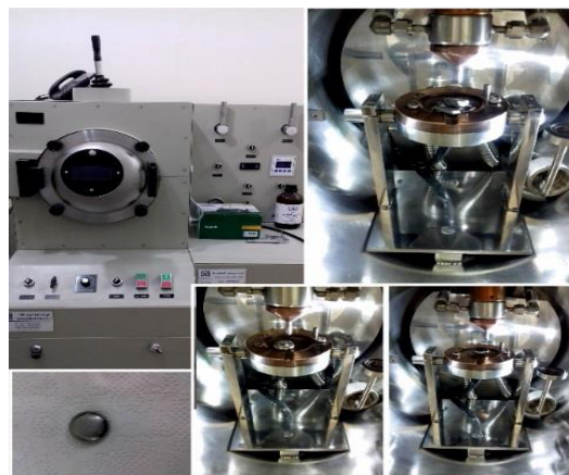
شکل ۱: نمایی از کوره ذوب مجدد قوس الکتریکی تحت خلأ.
