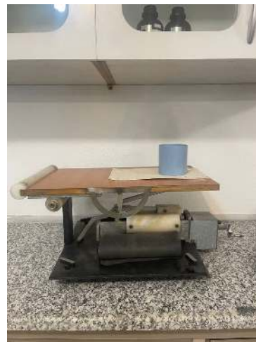
شکل ۱. دستگاه اندازه گیری ضریب اصطکاک ایستایی
