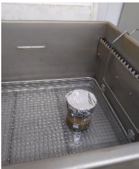
شکل ۱- نمونه داخل حمام اولتراسوند
