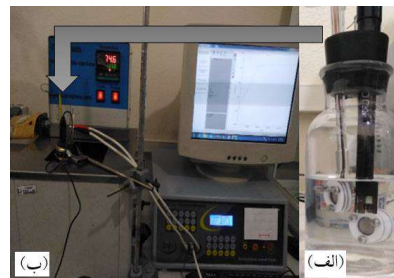
شکل ۲: سیستم اندازه‌گیری ظرفیت الکتروشیمیایی آلیاژ جاذب هیدروژن.
