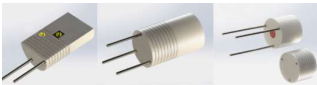
شکل ۱. تصویر ساز و کار پیشنهادی این پژوهش. (۱) آشکارساز \text{LiI}(\text{Eu}) در مرکز سامانه (۲) لایه‌های کندکننده پلی‌اتیلنی قابل تغییر.
